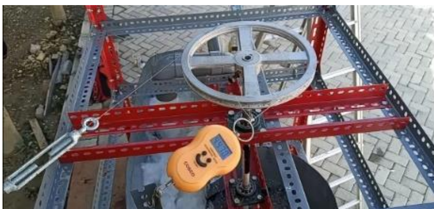
Gambar 7. Mengukur rpm dan Massa Pulley
