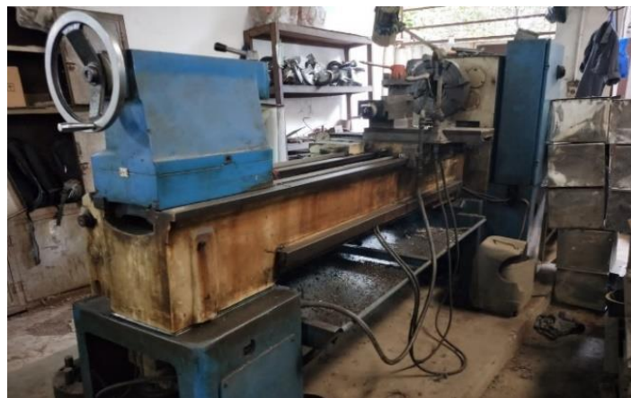
Gambar 1. Mesin Bubut Konvensional di PT. RAI
