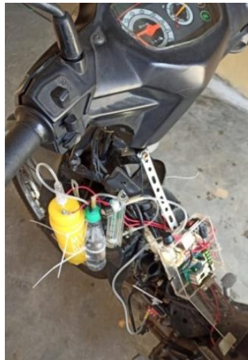
Gambar 2 . Rancangan elektroliser pada sepeda motor
