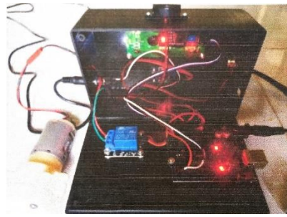
Gambar 11. Rangkaian alat pendeteksi dan pengendali gas amonia
