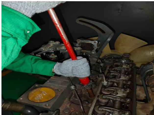
Gambar 9 . Pelepasan injector nozzle menggunakan sliding hammer
