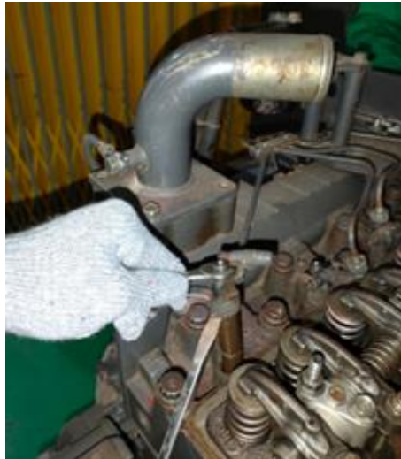
Gambar 3. Pelepasan injector nozzle menggunakan common tools
