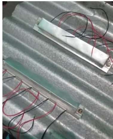
Gambar 5. Rangkaian TEG pada Atap
