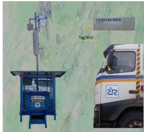
Gambar 3 Reader RFID dan Tag yang terpasang di dashboard trailer
