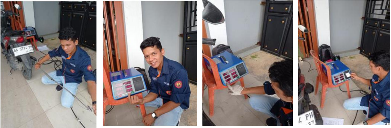
Gambar 6. Pengujian Emisi Gas Buang, a). Memasang Instrumen Four Gas Analyzer , b). Memulai Pengujian, c). Menghentikan Proses Pengujian, d). Melakukan Print Out Hasil Uji Emisi
