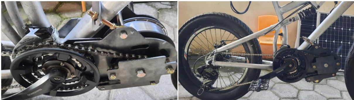
Gambar 8 . Tampilan frewheel crank dan bracket motor BLDC
