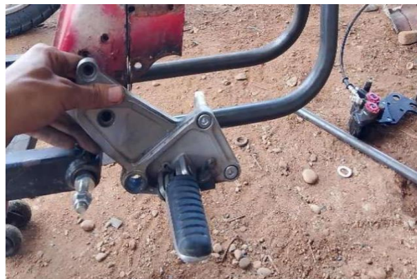
Gambar 7. Pembuatan pijakan kaki pengendara
