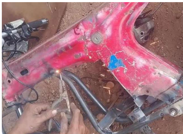
Gambar 5 . Pembuatan tempat baterai
