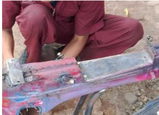
Gambar 6. Pembuatan tempat kontrollor
